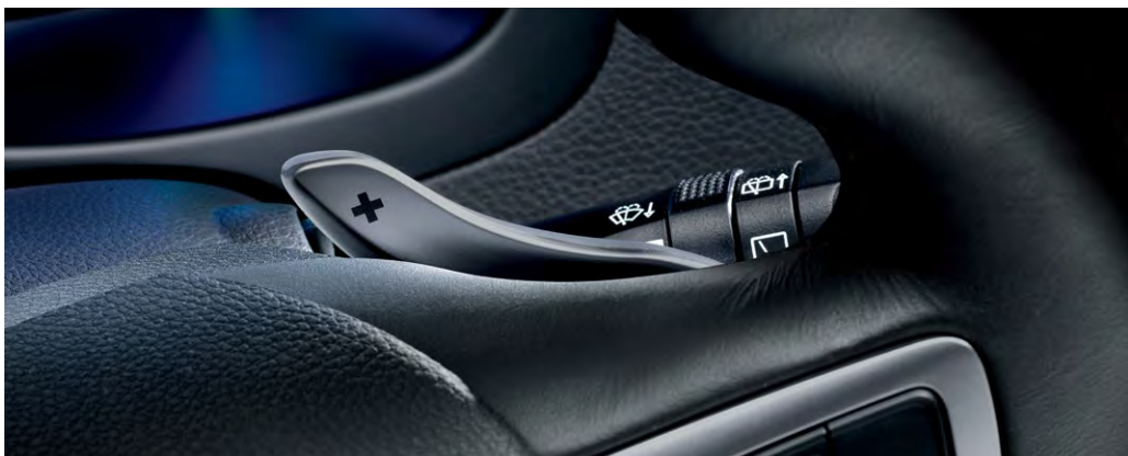
Sterowanie skrzynią biegów przy pomocy łopatek (tylko dla 7DCT)
