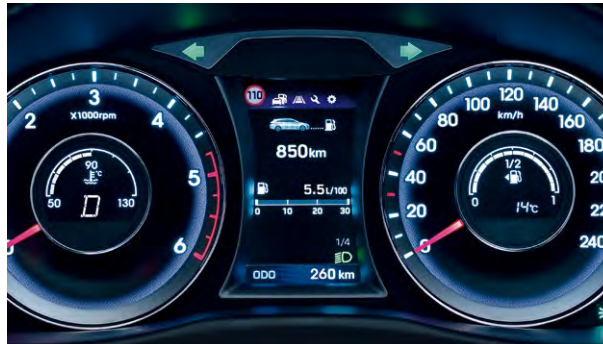
Zestaw wskaźników typu Supervision z wyświetlaczem TFT LCD 4,2"
