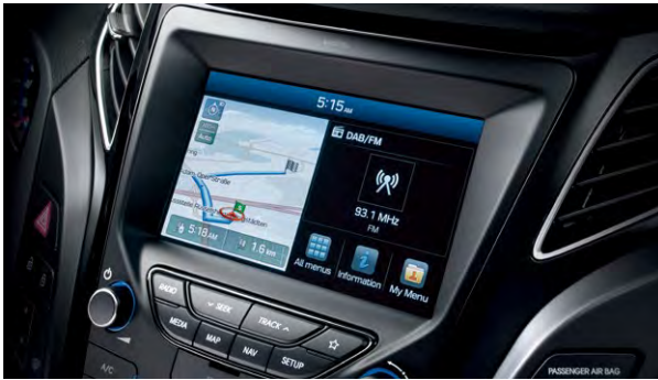
Nawigacja z wyświetlaczem 7", kamerą cofania i radiem cyfrowym
